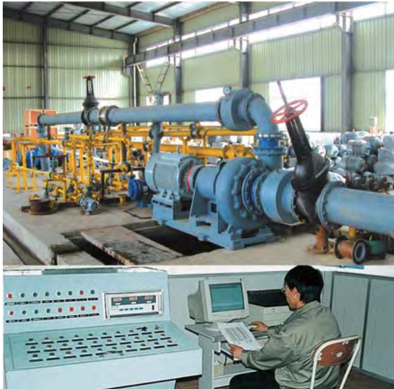
▲ 2000m 3 /h泵全性能测试台
