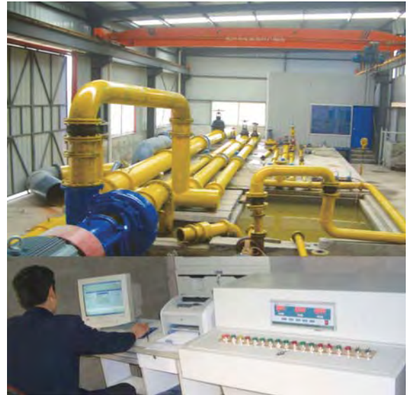
▲ 8000m 3 /h泵全性能测试台
